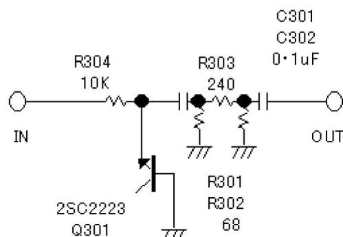
Occorre inoltre generare un'onda quadra 0-28V che "accenda e spenga" il generatore di rumore con una frequenza in banda audio, 7-800Hz vanno piu' che bene. Io ho utilizzato un NE555 che pilota un mosfet 2N7000, ma e' solo una delle n alternative.
